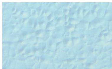
Polyamid Sphärolithe im Anschliff, Auflicht, geätzt - Interferenzkontrast
