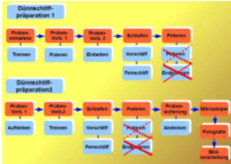
Abb. 4.9 Arbeitsablauf zur Herstellung eines manuellen Dünnschliffes
