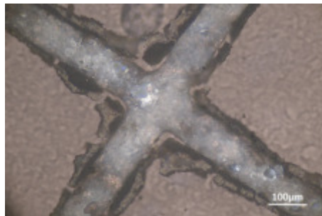
Abb. 6.45 Als Mischlichtverfahren eignet sich besonders die Kombination (simultan) von Auflicht und Durchlicht Polarisation. Sie erlaubt die Darstellung aller Phasen und die gesamten Gefügeeigenschaften
