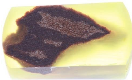
Ungenügende Infiltration, Sandstein Baustoff
