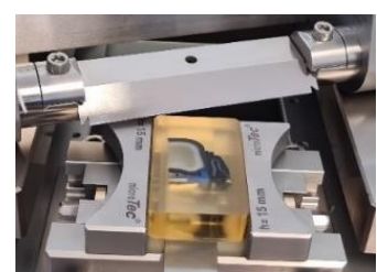
Schnittabnahme am Großschnittmikrotom
