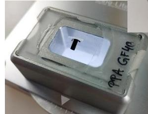
Halter mit Bohrung für Objektträger (80000025)
