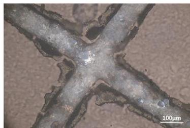
Abb. 6.45 Als Mischlichtverfahren eignet sich besonders die Kombination (simultan) von Auflicht und Durchlicht Polarisation. Sie erlaubt die Darstellung aller Phasen und der gesamten Gefügeeigenschaften.
