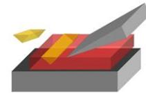
Freiwinkel zu steil eingestellt ( $>15^\circ$ ). Das Messer beschädigt die Probe und das Messer.
