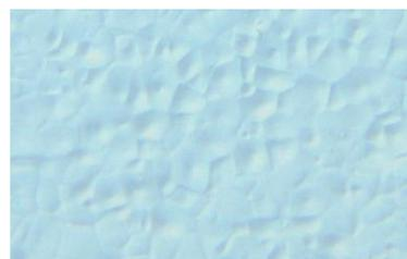
Abb.6.32 Polyamid Sphärolithe im Anschliff, Auflicht - Interferenzkontrast
